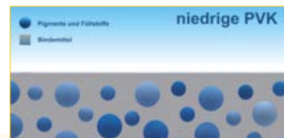
Pigmente und Füllstoffe sind gut von der Bindemittelmatrix umhüllt und vor Auswaschungen geschützt.
