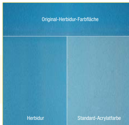
Farbveränderungen an den Bewitterungsflächen: links Herbidur und rechts eine Standard-Acrylatfassadenfarbe
